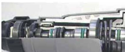
Système IMB et carter en magnésium pour une plus grande rigidité, une durabilité plus longue et une meilleure absorption des vibrations
