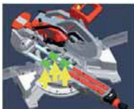
Guidage double monté sur 3 blocs roulements aiguilles
